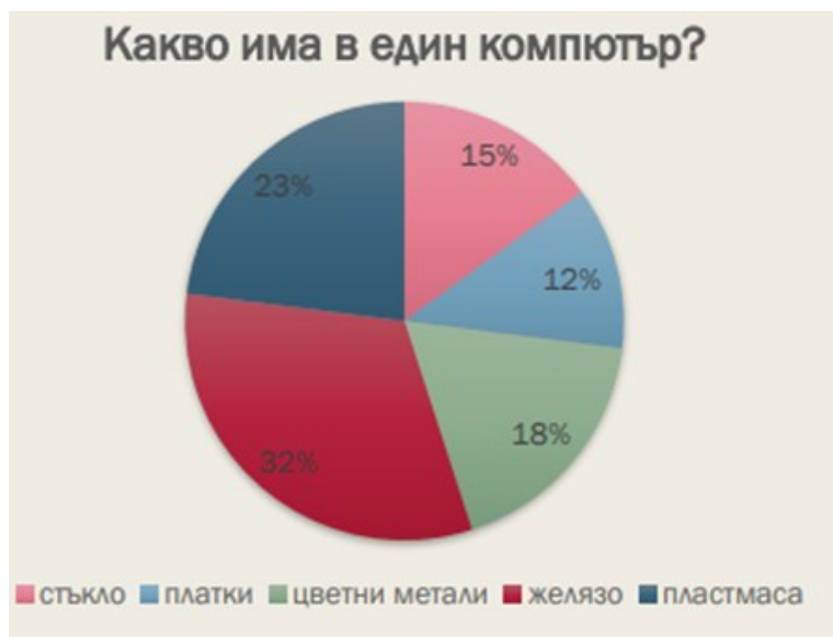
Фигура 1: Елементи, използвани при производство на компютър
